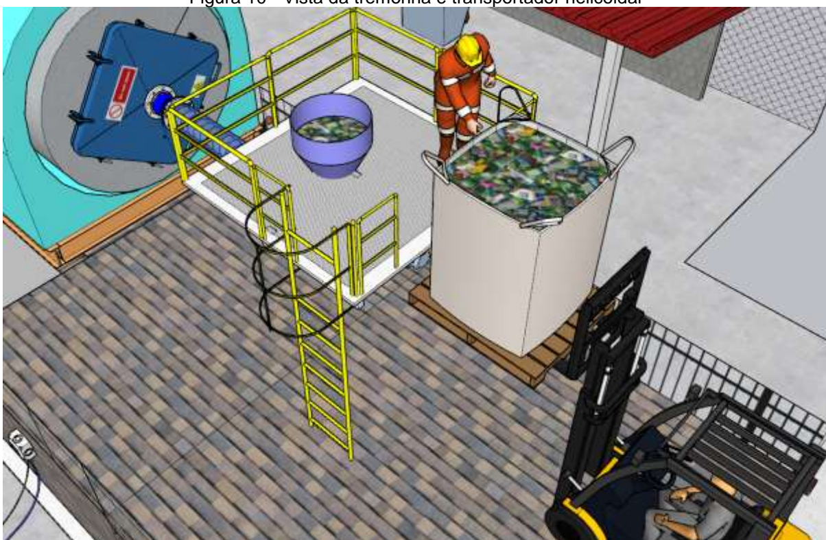
Figura 10 - Vista da tremonha e transportador helicoidal
