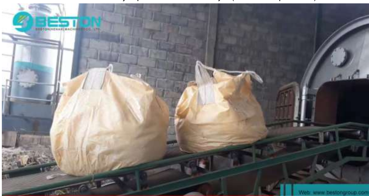
Foto 17 - Alimentação por meio de um conveyor (esteira transportadora)
