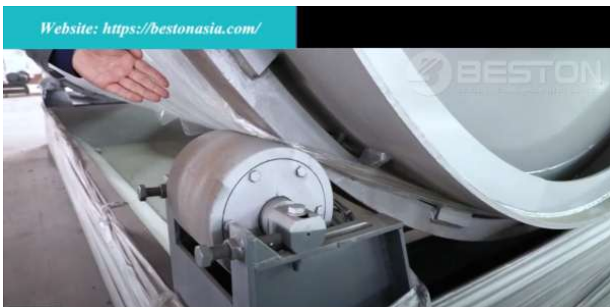
Foto 19 - Detalhe mostrando rolo e anel do reator
