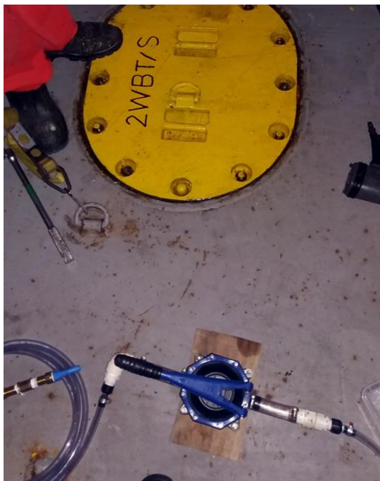
Figura 25 - Bomba adaptada de captação de amostra de lastro
