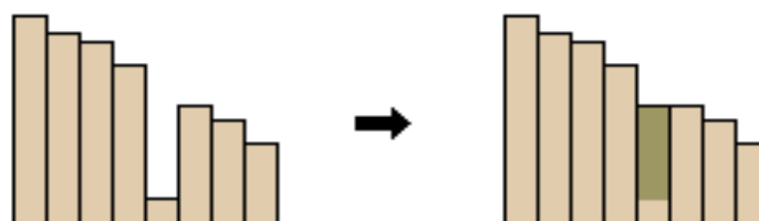
Figura 24 – Ilustração de funcionamento da ferramenta “Fill” do ArcGIS
