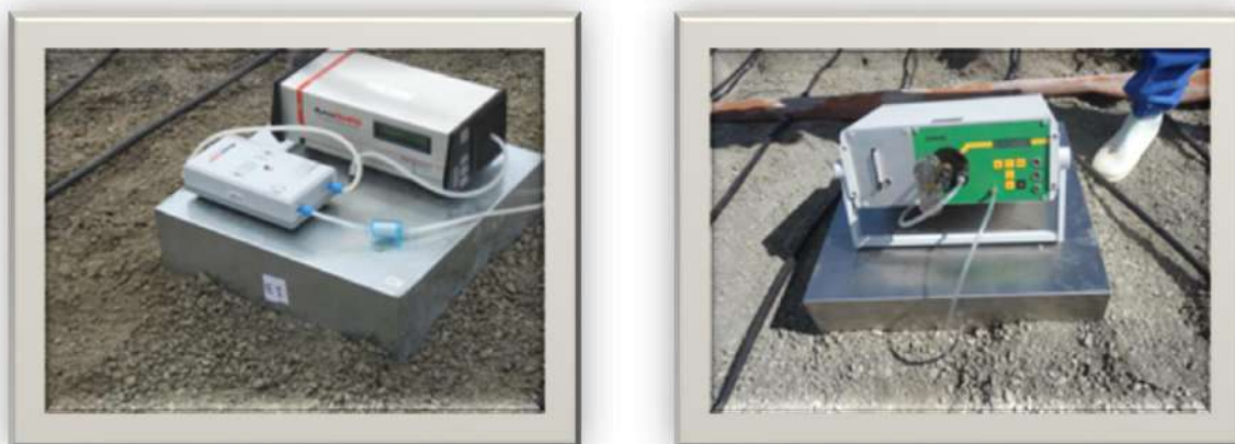
Figura 25 - Fotos dos equipamentos para medições in loco da taxa de exalação de radônio.
