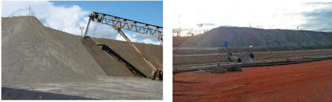
Figura 17 - Formação da pilha no pátio de lixiviação
