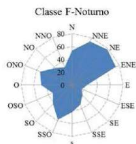
Figura A.9 – Frequência (%) da direção do vento ( 0^0 ) no período noturno versus a classe de Estabilidade F
