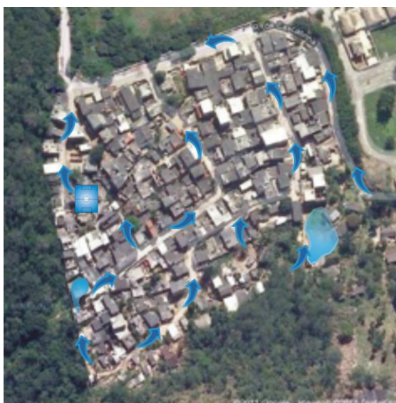
Figura 49 - Proposta de drenagem com menor grau de intervenção. Fonte: Modificado de Software Google Earth, acesso em 24/04/2012.
