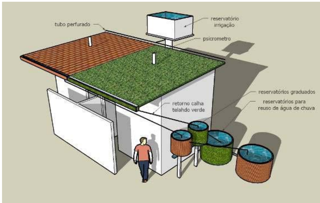
Figura 2 - Esquema de telhado verde – Projeto HIDROCIDADES.
