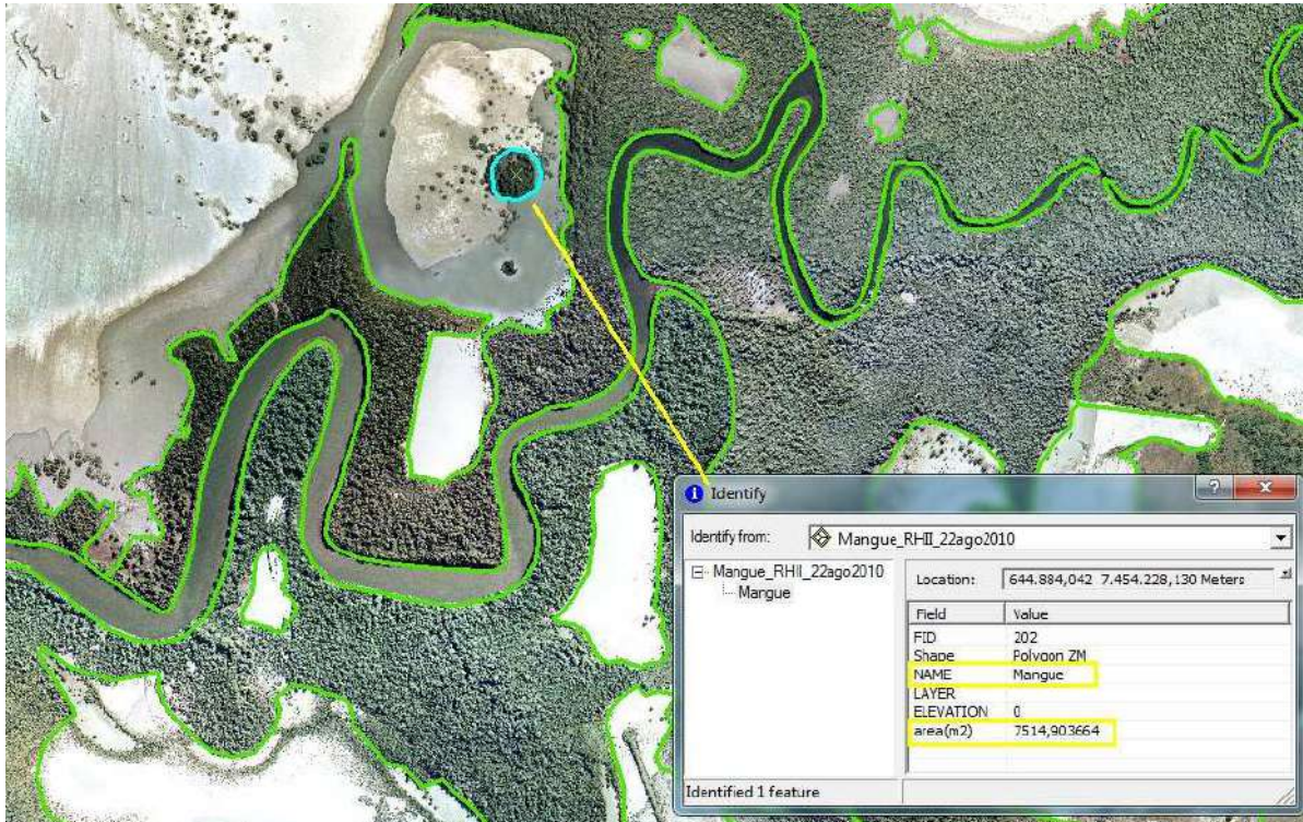
Figura 8 – Identificação do polígono com a informação da feição representada e respectiva área.
