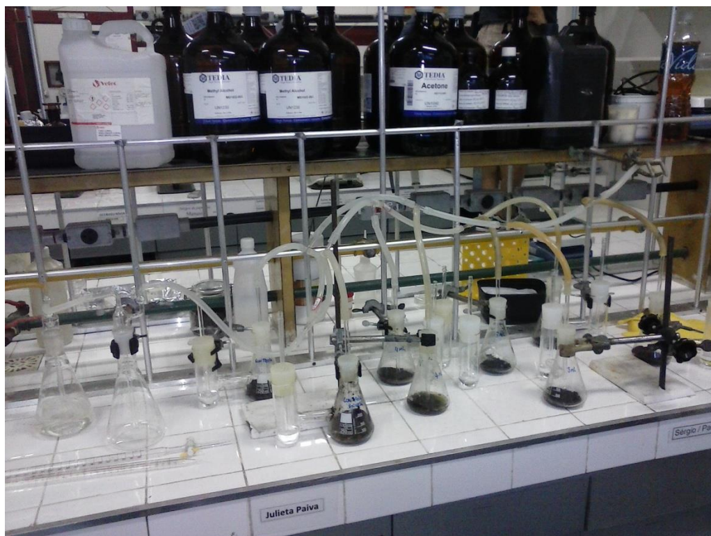
Figura 11 – Adaptação do respirômetro de Bartha para sistema dinâmico
