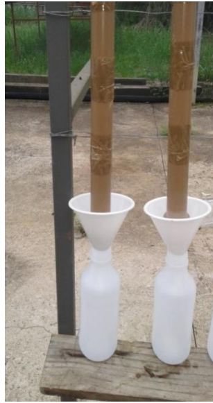
Figura 16 – Confecção e estabelecimento das colunas de solo
