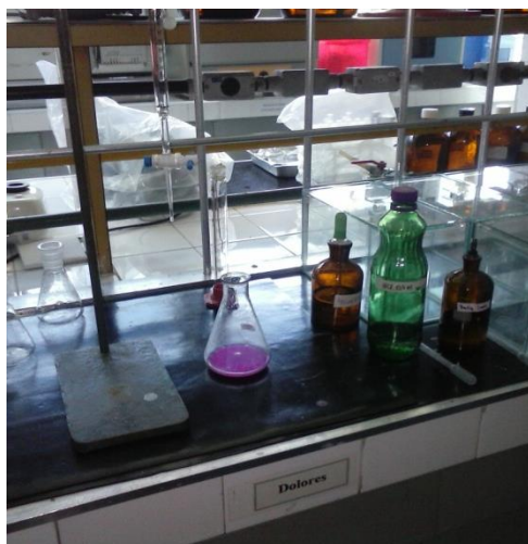
Figura 12 – Procedimento de titulação para avaliação da produção de CO 2
