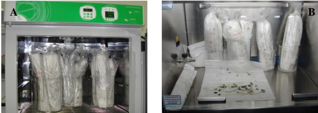
Legenda: A. Incubadora tipo BOD com os rolos de germinação verticalmente; B. Capela de fluxo laminar, onde foram contadas e avaliados todos os experimentos.
