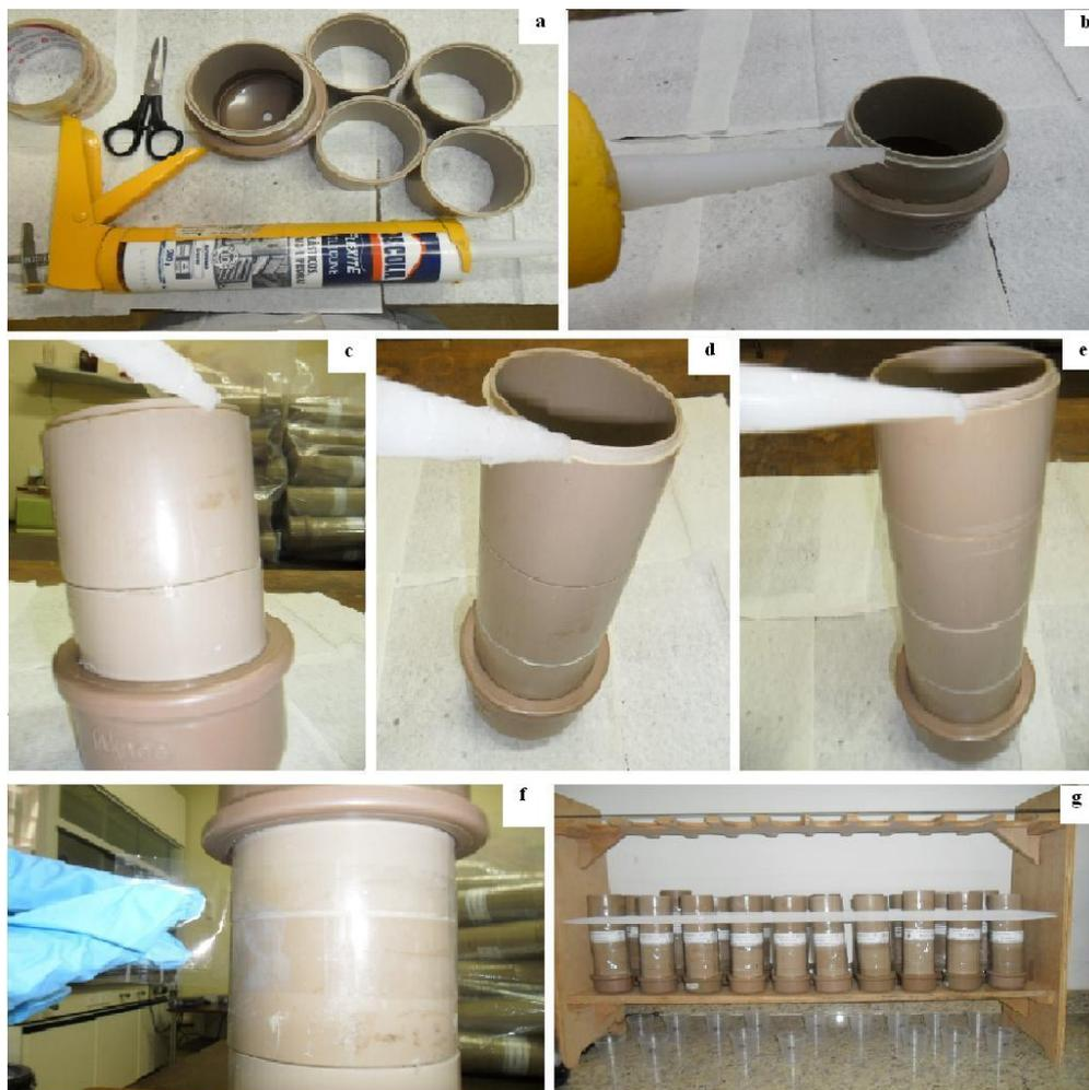
Legenda: (a) Material utilizado; (b), (c), (d) e (e) aplicação de silicone nos anéis das colunas; (f) colocação da fita adesiva; (g) colunas etiquetadas e organizadas no suporte.
