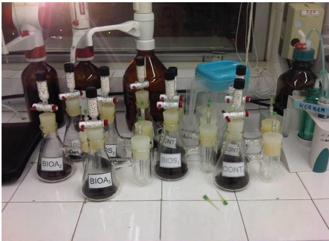
Figura 44 - Montagem dos respirômetros
