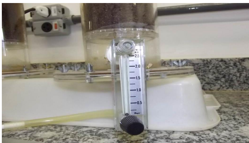
Figura 50 - Rotâmetro de marca Dwyer utilizado para controlar a vazão de ar na entrada de cada biorreator.
