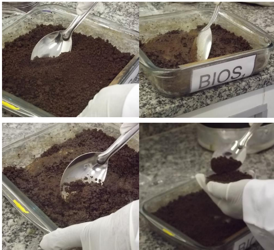
Figura 53 - Montagem, aeração, umidificação e amostragem dos microcosmos
