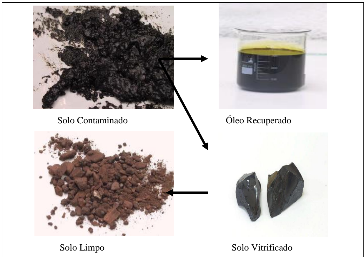
Figura 21 - Solo Contaminado por petróleo submetido ao tratamento por plasma
