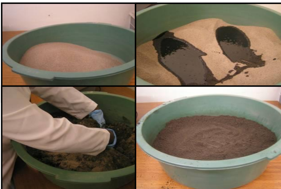
Figura 41 - Foto ilustrativa do procedimento de recontaminação de solo
