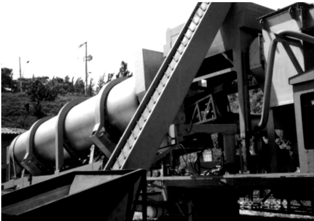
Figura 14 - Incinerador de Resíduos
