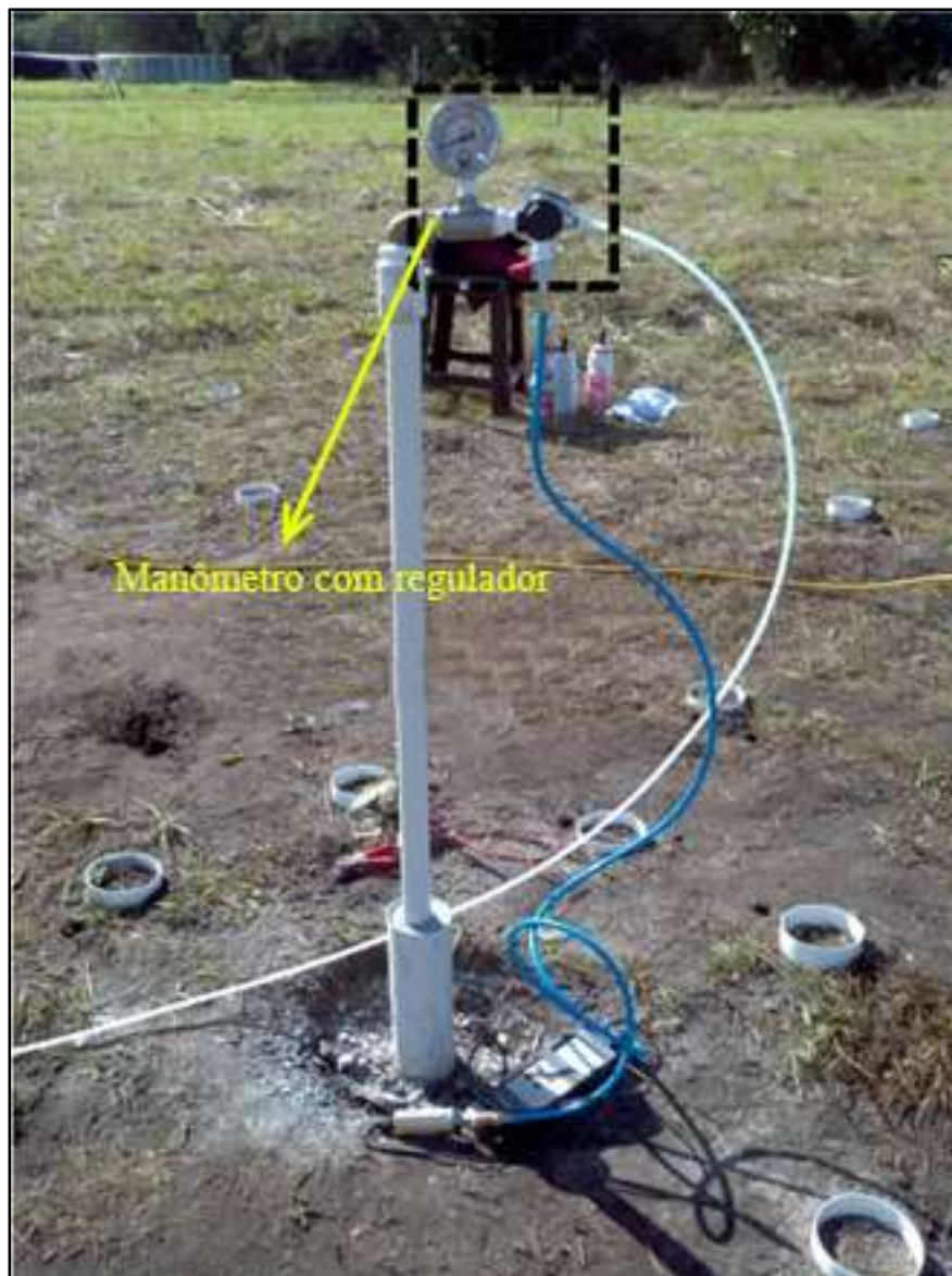
Figura 1.2.1 – Detalhe do sistema de controle de injeção de CO 2 gasoso no subsolo, no experimento de 2013.
