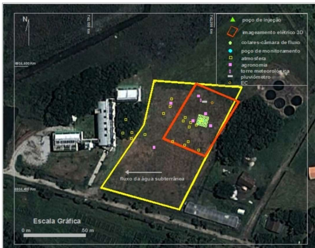
Figura 3.3.2.1: Visão da distribuição espacial em campo dos diversos trens de medição, utilizados no experimento, aí identificados. Destacam-se as malhas amostrais da geofísica (vermelho) e as câmaras de fluxo (amarelo, circunscrevendo o poço de injeção de CO 2 ).
