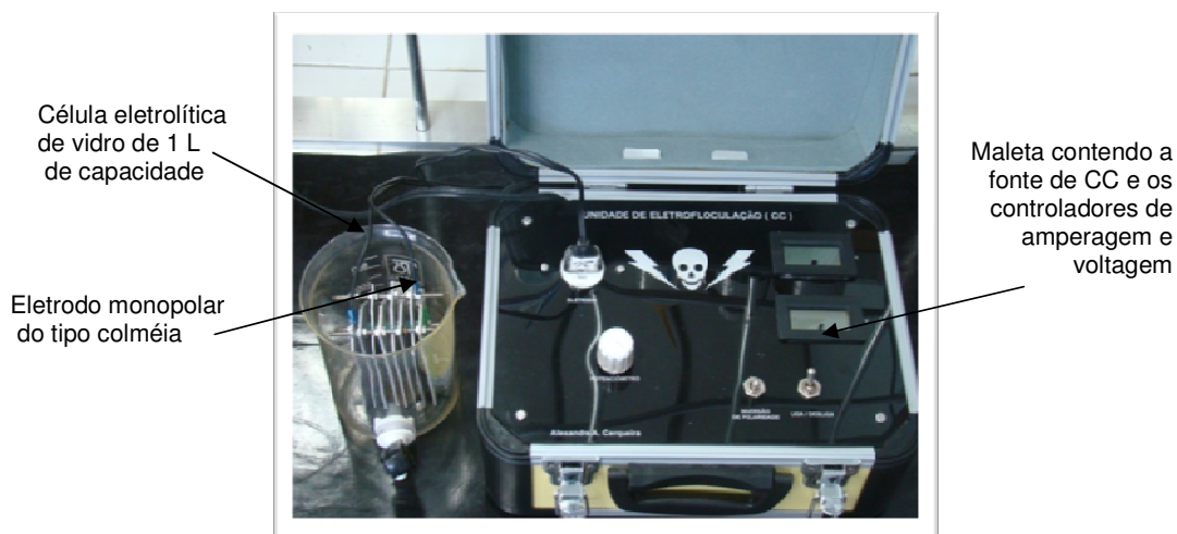
Figura 23 - Unidade piloto de eletrofloculação com corrente contínua.
