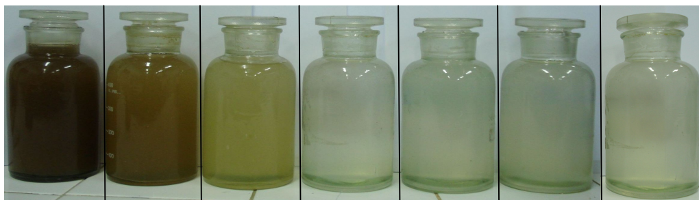
Figura 35 – Aspectos visuais das águas oleosas AOMS antes e após a EF. Legenda: Da esquerda para a direita: efluente bruto e tratado com diferença de pHs (bruto; 4; 5; 6; 7; 8 e 9). Utilizando CA com f = 60 Hz, t = 3 min., i = 3 A e D_{\text{eletrodo}} = 0,5 cm.
