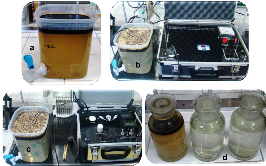
Figura 42 – Ensaio de eletrofloculação em efluente real com baixa salinidade. Legenda: a) efluente bruto; b) efluente eletrofloculado com CA; c) efluente eletrofloculado em CC e d) efluente bruto e eletrofloculado em CA e CC. Nota: Ensaio realizado com t = 15 min.
