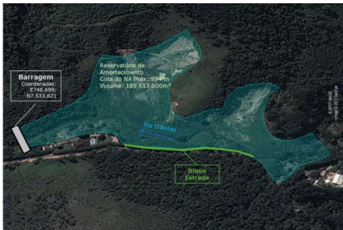
Figura 77 – Barragem de Cardinot e reservatório de amortecimento.
