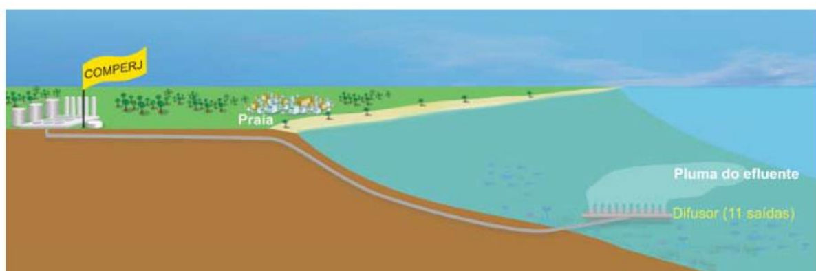
Figura 13 – Desenho esquemático do emissário terrestre e submarino do Comperj
