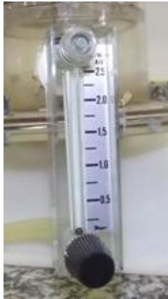
Figura 19 - Medidor analógico de vazão de gases - marca Dwyer
