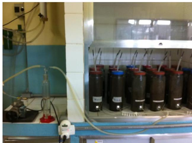
Figura 20 - Sistema de tratamento por aeração forçada de solo contaminado com diesel B5
