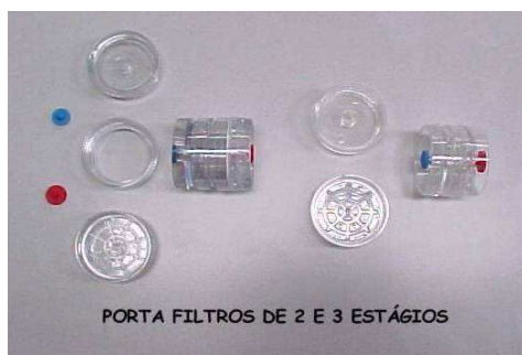
Figura 11. Montagem dos porta filtros
