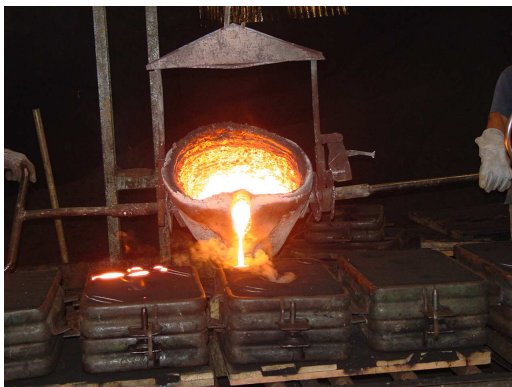
Figura 7. Vazamento no molde de areia verde
