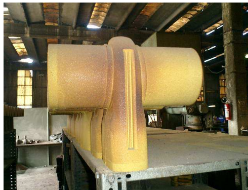
Figura 5. Molde de areia verde com macho Figura 6. Macho feito de areia shell
