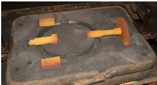
Figura 5. Molde de areia verde com macho Figura 6. Macho feito de areia shell
